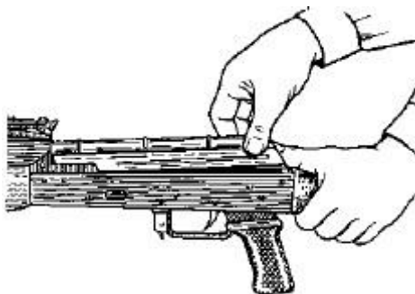
Рис. 13. Отделение крышки ствольной коробки
