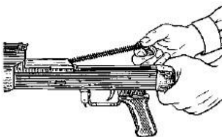
Рис. 14. Отделение возвратного механизма
