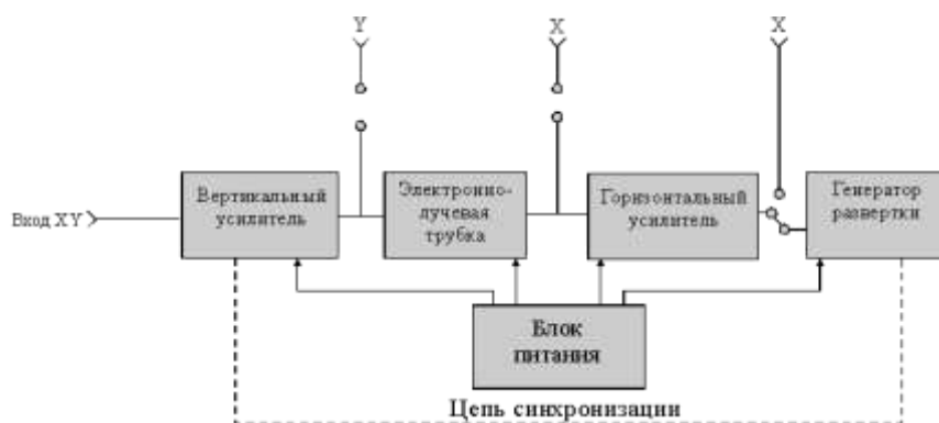
Рис.1 Блок-схема простейшего осциллографа.
