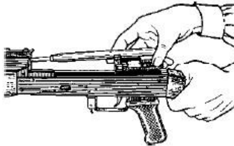
Рис. 15. Отделение затворной рамы с затвором
