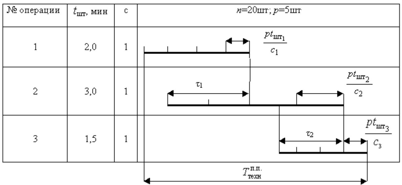
Рис.3. График технологического цикла при параллельно-последовательном
