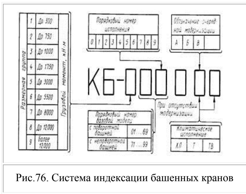
Рис.76. Система индексации башенных кранов
