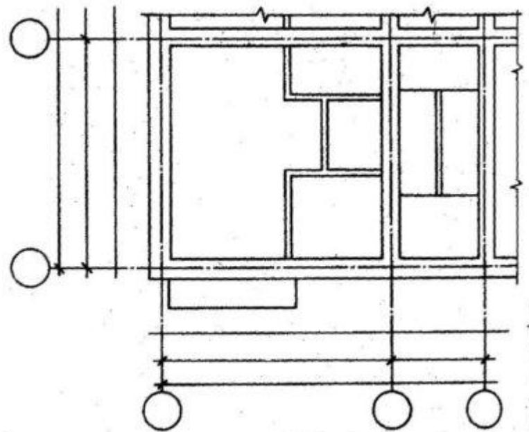
Рисунок 193 - Нанесение на плане стен здания
