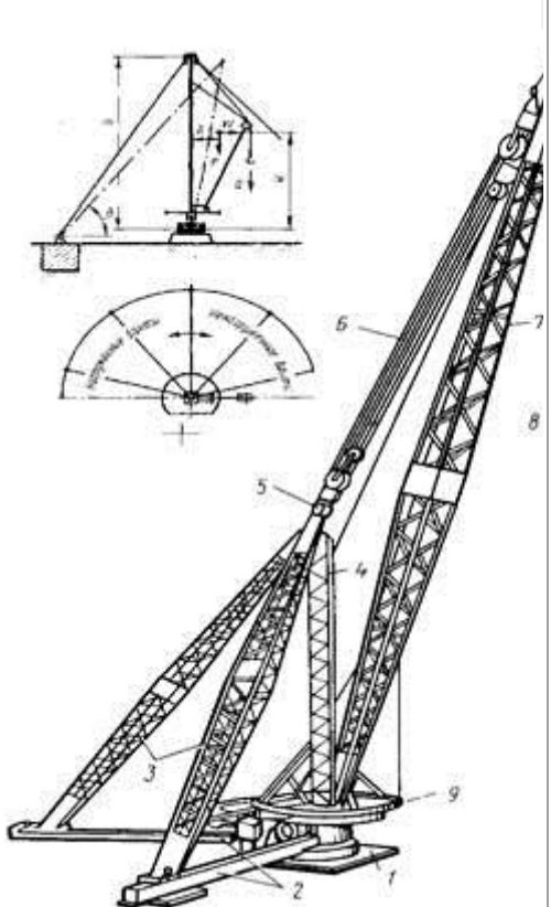
Рис.75. Подкосный мачтово-стреловой кран со схемой к расчету натяжений в вантах
