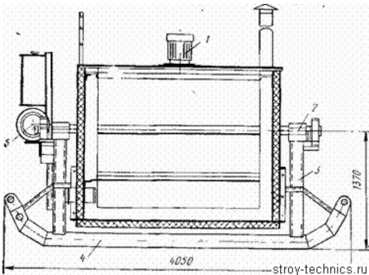
Рис. 179. Котел для варки битума УБв-1 с поворотным устройством
