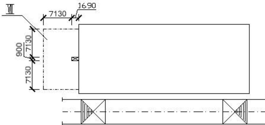
Рис. 9. Опасная зона работы подъёмника. VII – опасная зона работы подъёмника
