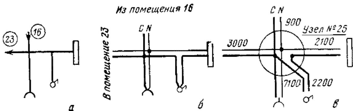
Рис. 8.6. Схемы соединения осветительной электропроводки в узле № 25:
