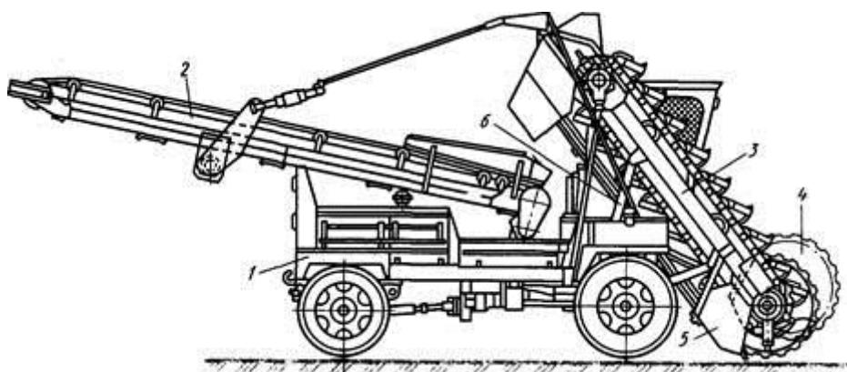
Рис. 72. Многоковшовый погрузчик со шнекоковшовым рабочим органом
