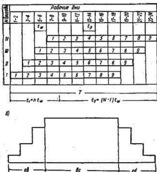
Рис. 2. Производство работ поточным методом с постоянным ритмом
