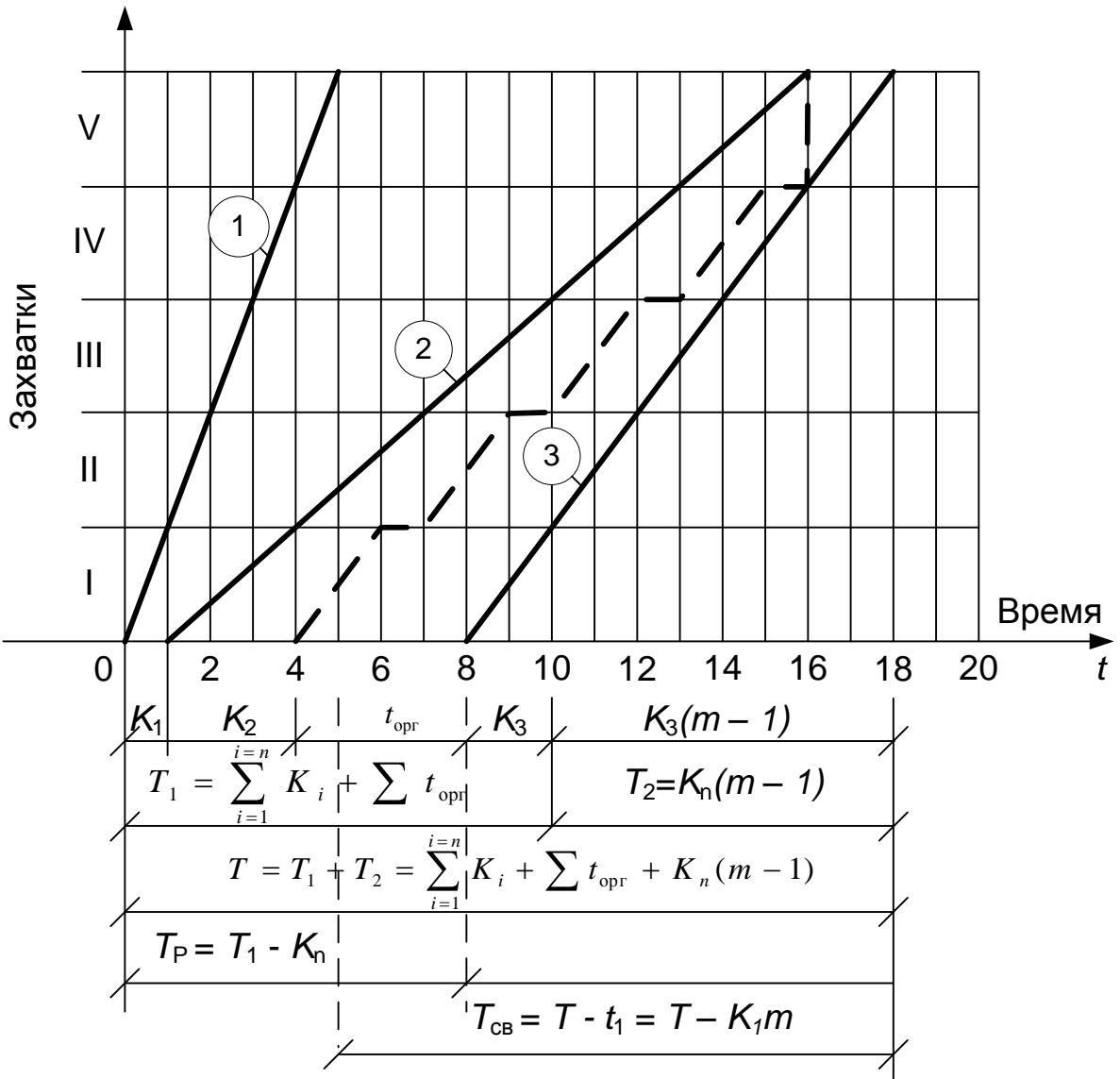
Рисунок 3.5 Модель разноритмичного потока в виде циклограммы
