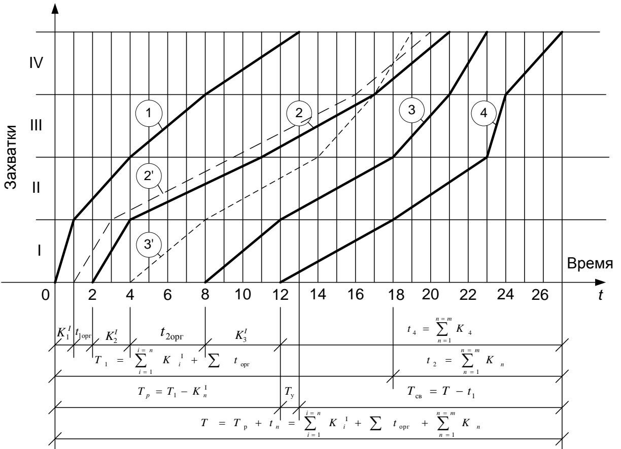
Рисунок 3.6 Модель неритмичного потока в виде циклограммы:
