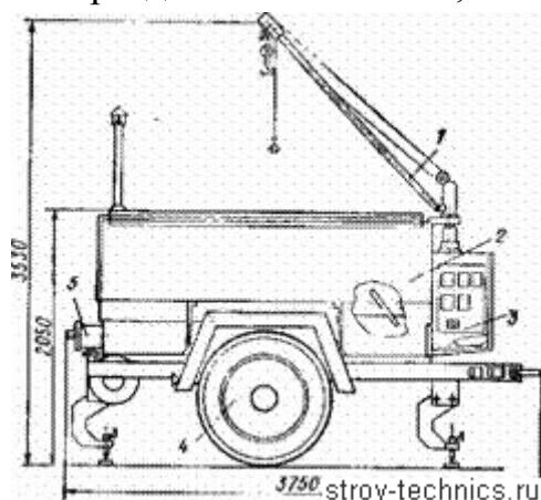
Рис. 183. Установка для варки битума передвижная УБВ-3
