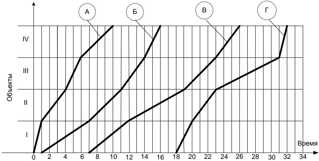
Рисунок 3.8 Модель исходного варианта потока в виде циклограммы
