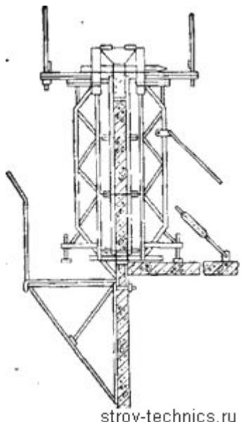
Рис. 104. Унифицированная крупнощитовая опалубка
