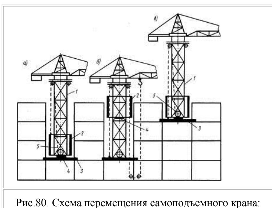
Рис.80. Схема перемещения самоподъемного крана:
