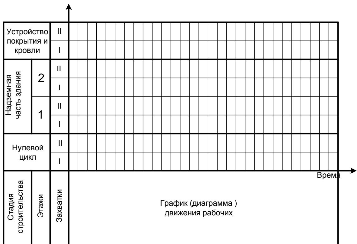
Рисунок 3.11 Форма модели строительства объекта в виде циклограммы
