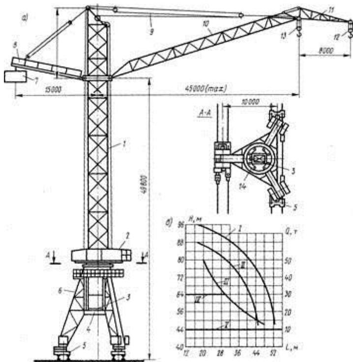
Рис.81. Специальный монтажный кран с грузовым моментом 10000кН·м: а - схема крана; б - график грузоподъемности и высоты подъема крюка; / - высота подъема вспомогательного крюка; // -то же, основного крюка; /// - грузоподъемность при четырехкратном полиспасте; /V - то же, при двухкратном полиспасте: V - грузоподъемность вспомогательного крюка
