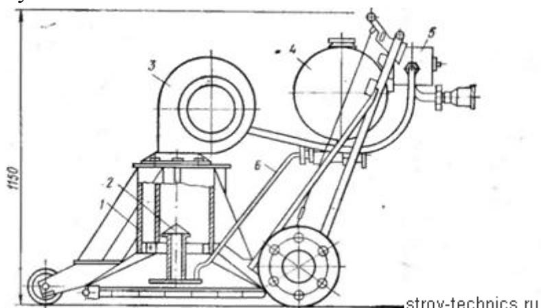
Рис. 174. Машина СО-107 для сушки оснований кровли
