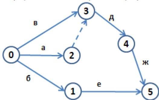
**Рис. 12. Неправильное использование фиктивных работ**
