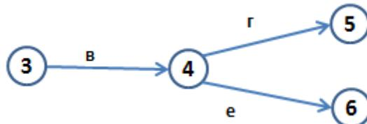
**Рис. 4. Изображение работ выполняемых после одной и той же работы**
