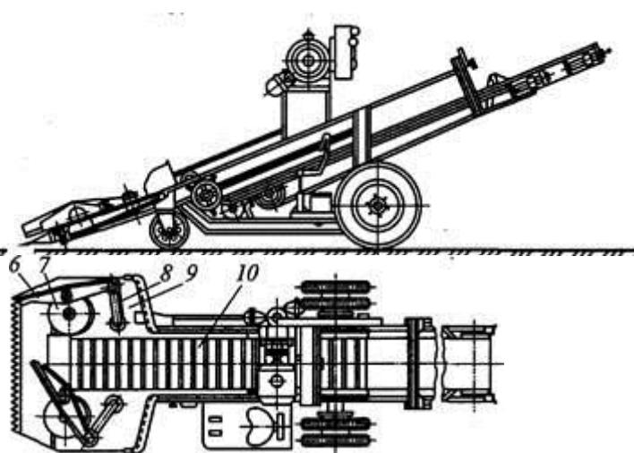
Рис.73. Погрузочная машина непрерывного действия с загребающими лапами
