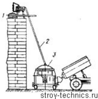
Рис. 181. Установка для приготовления, хранения и подачи горячих мастик или битума на кровлю УХМП-1
