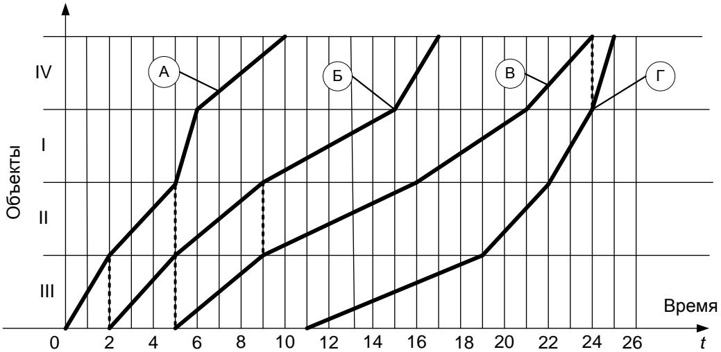
Рисунок 3.10 Модель оптимального варианта потока
