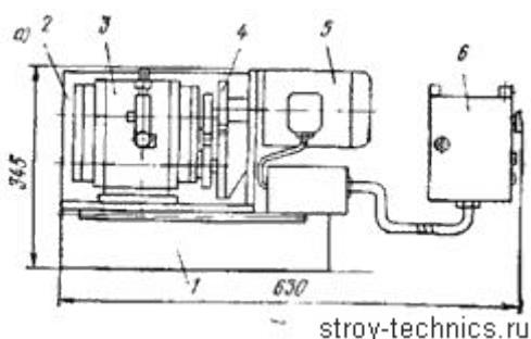
Рис. 175. Агрегаты СО-119 (а) и СО-120 (б) для перекачки битумных мастик
