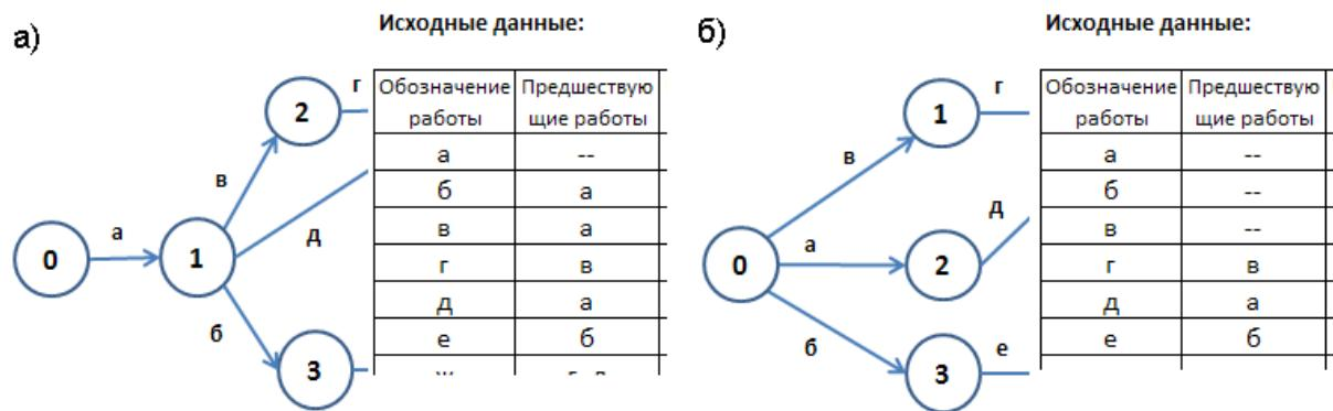
**Рис. 2. Пример построения начала сетевого графика**
