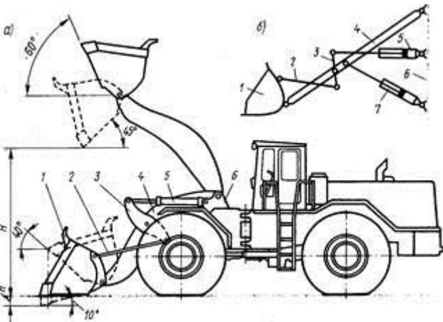
Рис. 68. Одноковшовый фронтальный погрузчик: а—схема конструкции; б—кинематическая схема погружочного оборудования
