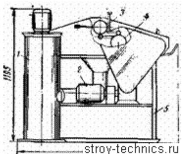
Рис. 171. Машина СО-98 для очистки и перемотки кровельных материалов
