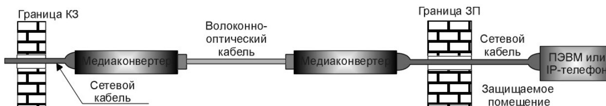
Рис. 2.4. Схема соединений с применением медиаконвертеров
