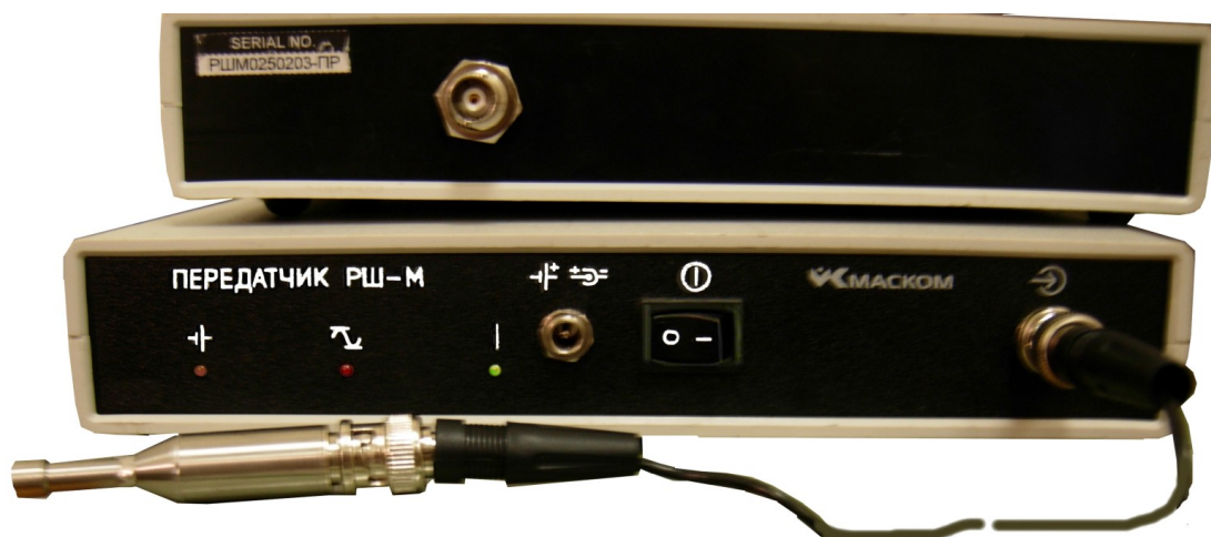
Рис. 3. Внешний вид задней панели приемника (сверху) и передней панели передатчика с подключенным микрофоном
