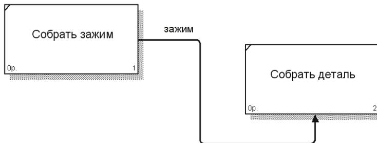
Рисунок 1.6 – Комбинированная стрелка *выход – механизм исполнения*
