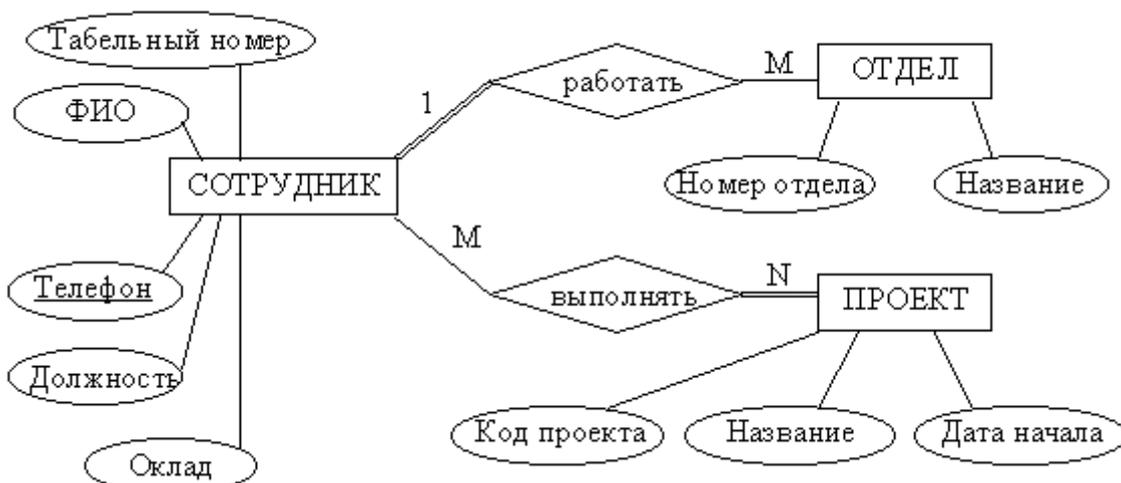
Рисунок 3.1 - Пример ER–диаграммы с однозначными и многозначными атрибутами
