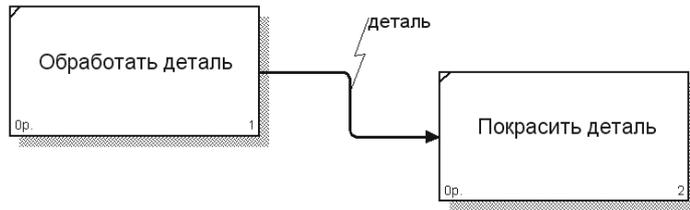
Рисунок 1.4 – Комбинированная стрелка *выход – вход*
