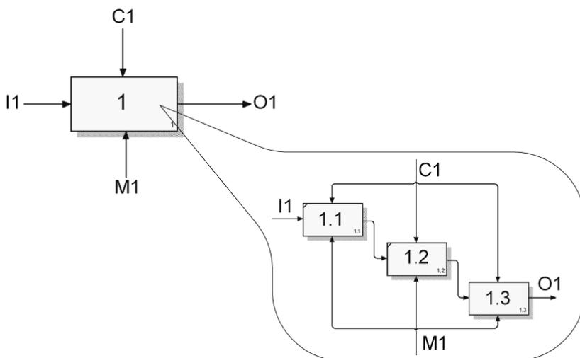
Рисунок 1.2 – Принцип декомпозиции
