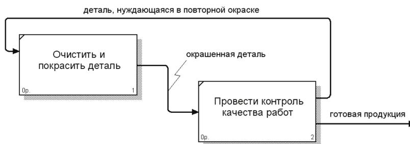
Рисунок 1.8 – Комбинированная стрелка *выход – обратная связь на вход*
