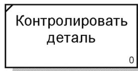
Рисунок 1.1 – Функциональный блок IDEF0
