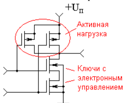
Рисунок 2. Принципиальная схема элемента "2И-НЕ", выполненного на комплементарных МОП транзисторах.
