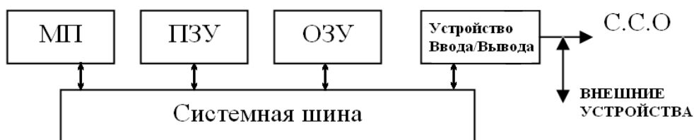
Рисунок 4- Взаимодействие блоков МП: МП – микропроцессор; ПЗУ – постоянное запоминающее устройство (ЗУ); ОЗУ – оперативное ЗУ; С.С.О. – схема сопряжения объектов
