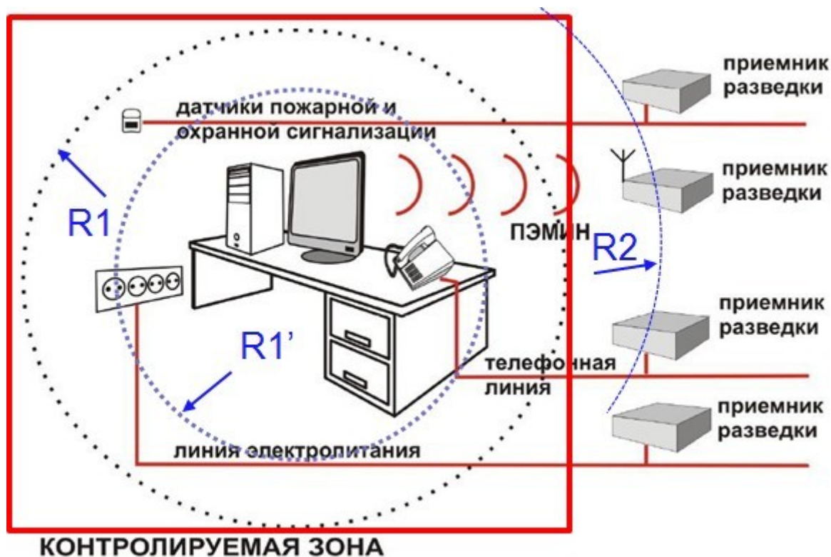
Рис 3.2 Радиусы опасных зон для перехвата информативных сигналов
