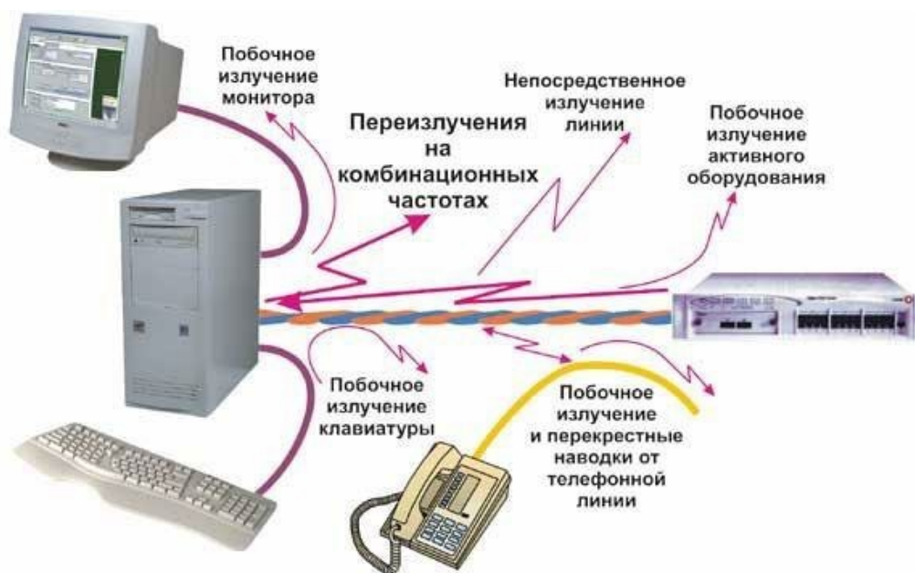
Рис 3.1 Основные источники возникновения ПЭМИ при работе СВТ
