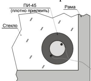
Рисунок 10 – Крепление генераторов-вибровозбудителей "СВ-4Б" на стекло
