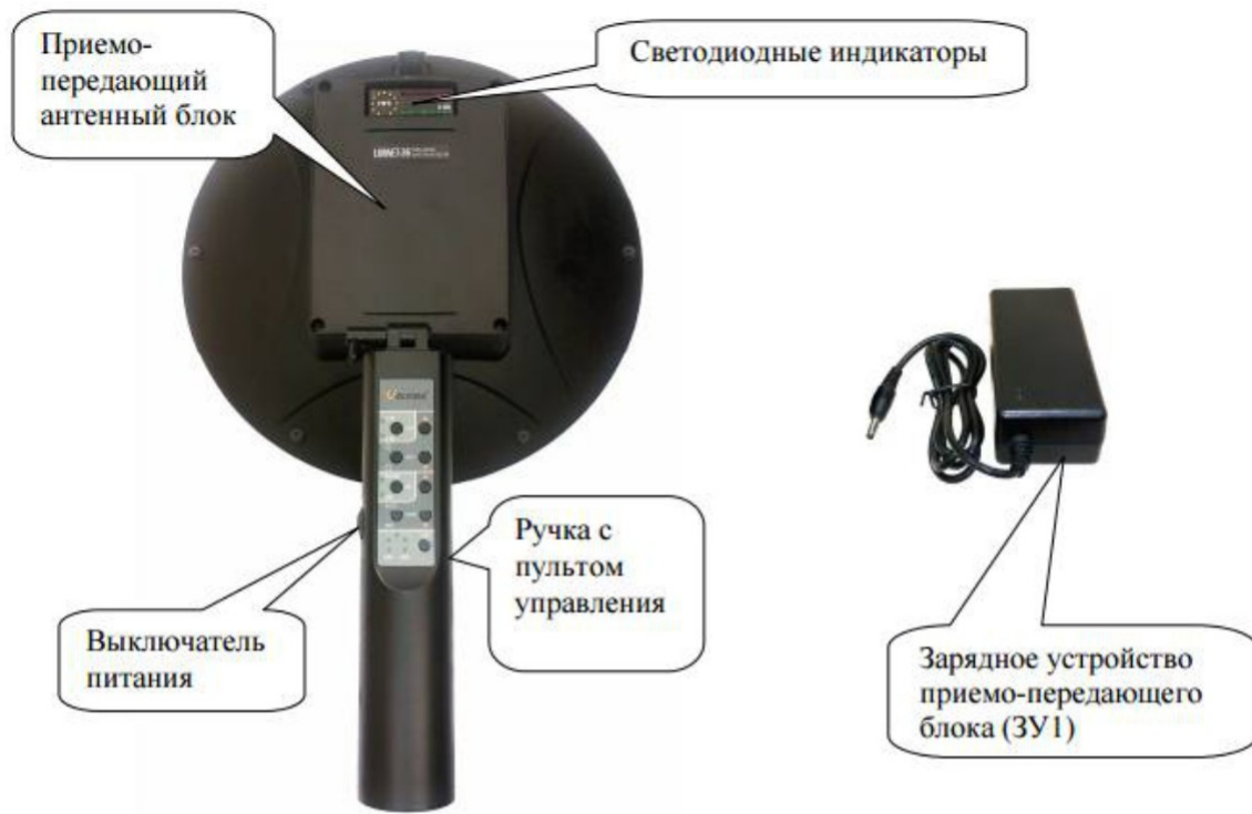
Рис. 1. Внешний вид обнаружителя и его зарядное устройство (ЗУ1).
