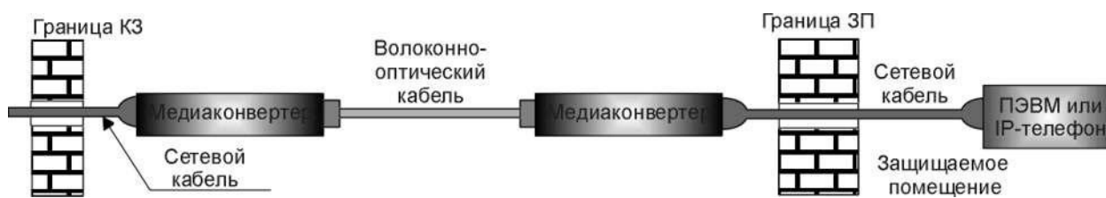
Рис. 2.4. Схема соединений с применением медиаконвертеров
