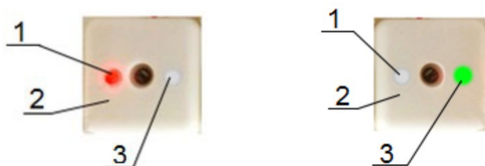
Рисунок 2 - Световой индикатор отображения состояния извещателя охранного магнитно-контактного в двух режимах работы
