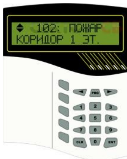
Рисунок 6 - Внешний вид пульта контроля и управления охранно-пожарного С2000М
