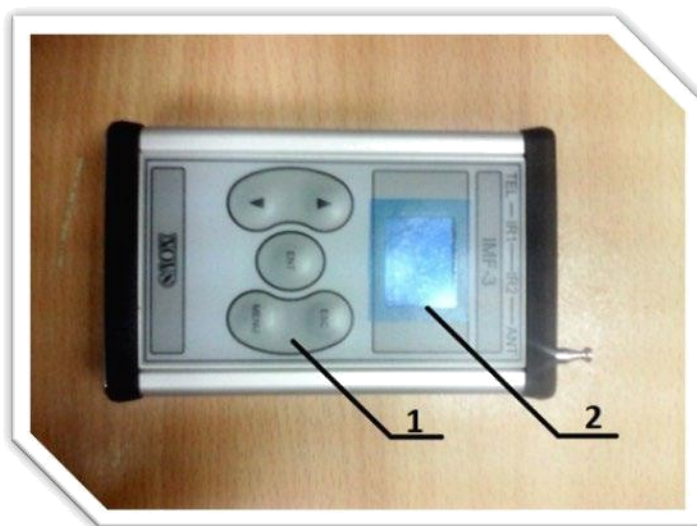
Рисунок 5.1 – Имитатор сигналов «ИМФ-3» (лицевая часть).
