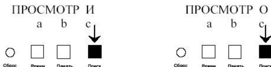
В режиме ПРОСМОТР И при нажатии крайней правой кнопки на экран последовательно (в порядке возрастания) выводятся частоты каналов, исключенных в режимах АВТОНАСТРОЙКА, ПОИСК (буферы А и В) и АВТОИСКЛЮЧЕНИЕ (буфер С), а также в режиме ПРОСМОТР О. Для удаления из памяти соответствующего буфера исключенного канала нажмите кнопку «Память»:
