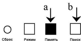
**АВТОИСКЛЮЧЕНИЕ:** Сканирование в автоматическом режиме, прекращается при нажатии кнопки «Сброс». Рекомендуется для быстрого анализа электромагнитной обстановки и обнаружения сигналов с признаком нелегально установленных передатчиков - высоким уровнем гармоник. Частоты исключенных и обнаруженных сигналов записываются в буфер С.
