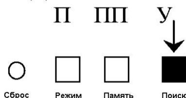
включения режима постановки помехи после остановки сканирования последовательно нажмите кнопку «Режим», при этом на ЖКИ отображается частота настройки и соответствующая надпись – «x2 » (до 667 МГц при повторном нажатии – «x3») или «ПЕРЕДАЧА».
