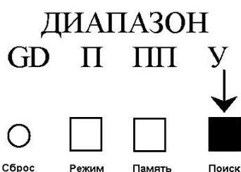
ПОИСК: После входа в режим выберите диапазон сканирования У – установленный диапазон частот, П – программируемый участок диапазона, ПП – два программируемых участка, GD – диапазоны стандартов GSM и DECT.
