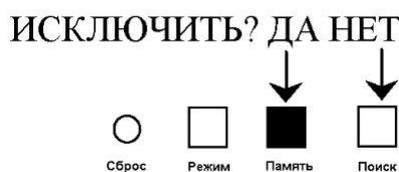
Повторное нажатие кнопки «Память» вносит среднюю частоту канала в список исключенных и переводит изделие в режим сканирования.
