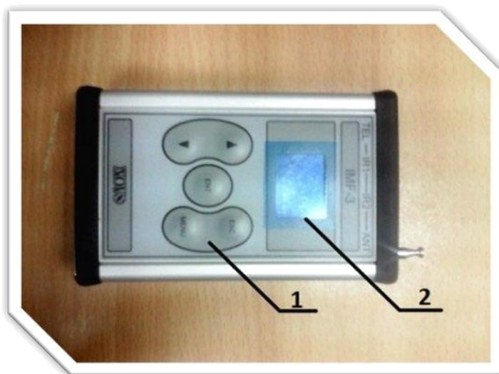
Рисунок 5.1 – Имитатор сигналов «ИМФ-3» (лицевая часть).
