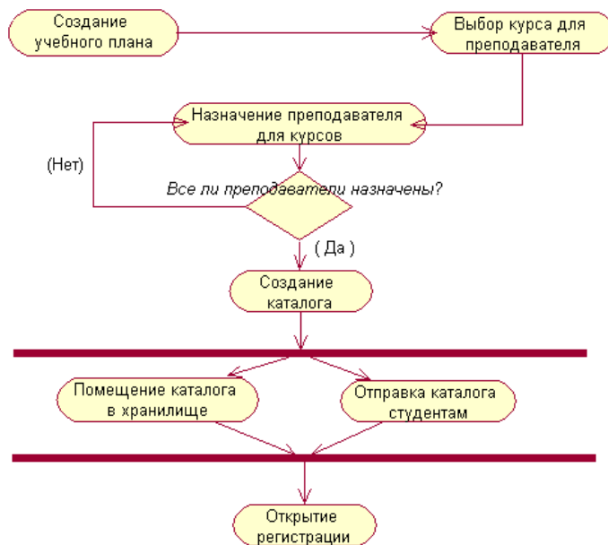
Рисунок 5.11 – Диаграмма деятельности, которая моделирует действия, выполняемые в процессе создания системы регистрации учебных курсов
