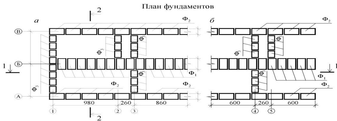
Рис. 1. Планы фундаментов и раскладки плит перекрытия над подвалом: l_1 a – для торцевой блок-секции; б – для рядовой блок-секции
