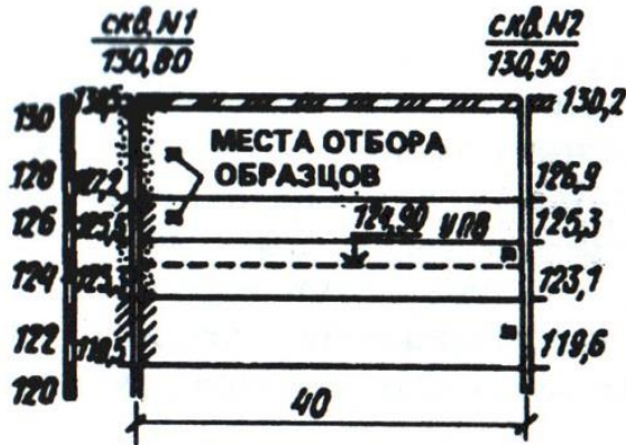
Рис. 1. 13. Геологический разрез строительной площадке 1 (к примеру 1)
