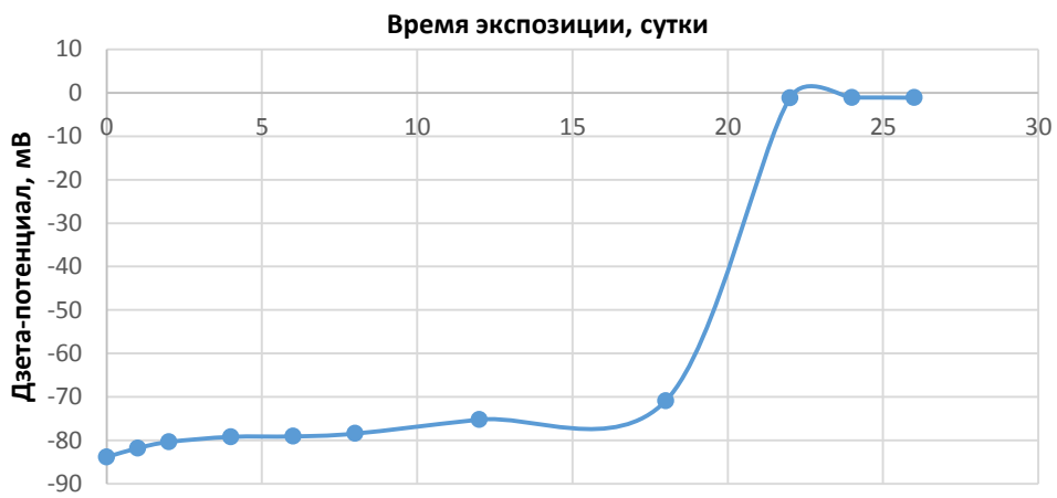
Рисунок 5 – Зависимость дзета-потенциала от времени экспозиции образца № 5 Figure 5 – Dependence of the zeta potential on the exposure time of sample № 5
