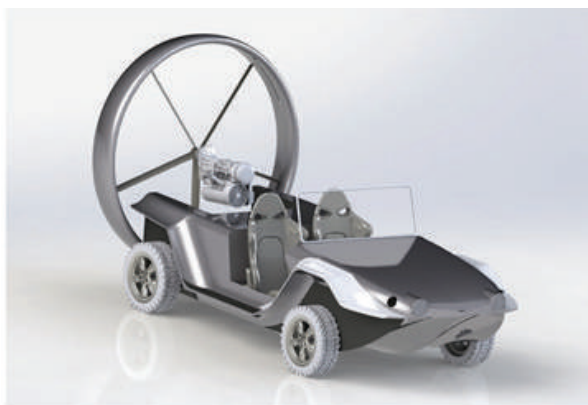
Рис. 2. Конструкция «Бегалет «Тритон»
