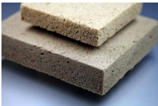
Рисунок 3. Древесный аэрозоль застывает, образуя полностью биоразлагаемые изоляционные панели
