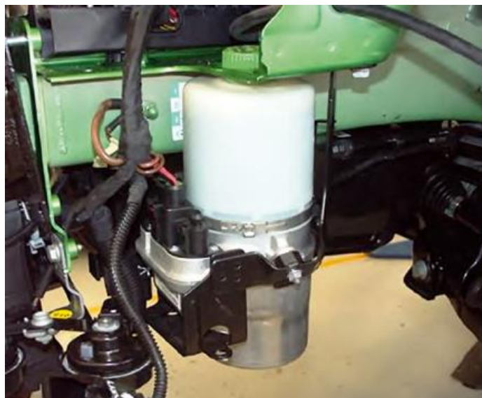
Рисунок 7 - Демонтирован бампер, электрогидравлический насос – как на ладони
