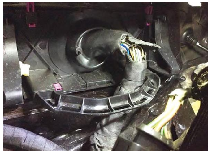
Рисунок 6 - Повреждение жгута электрической проводки
