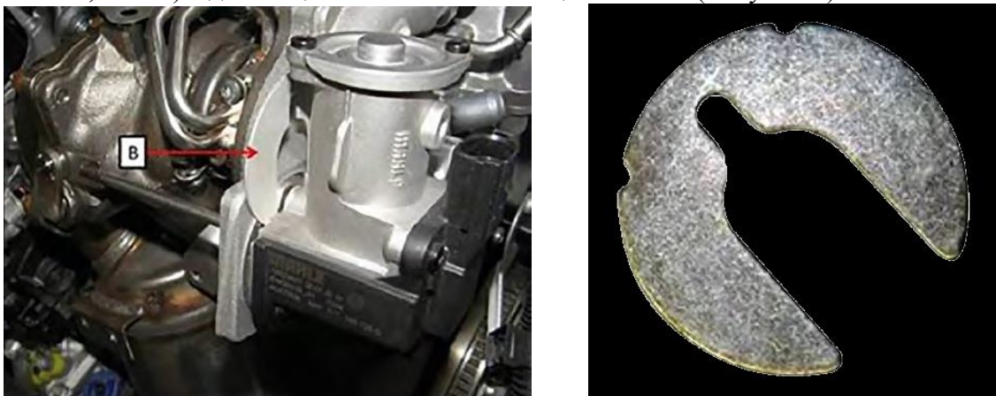
Рисунок 4 - Дистанционная шайба для регулирования требуемых показаний и ее местоположение
