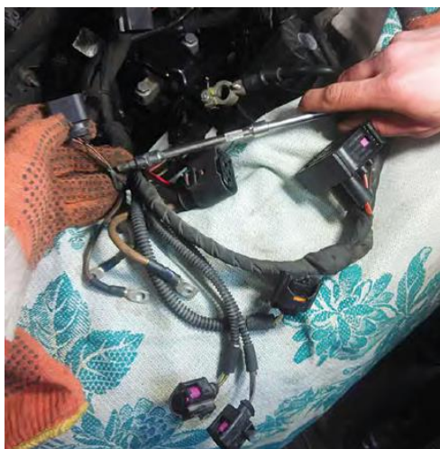
Рисунок 9 - Повреждение и окисление проводов, оплетка провода перетерта и они окислены.
