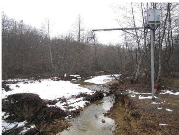
Рис. 5. Общий вид измерительного комплекса «ЭМЕРСИТ» на Г-образной консоли
