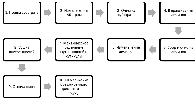
Рис. 3. Блок схема переработки насекомых в протеино-вую муку
