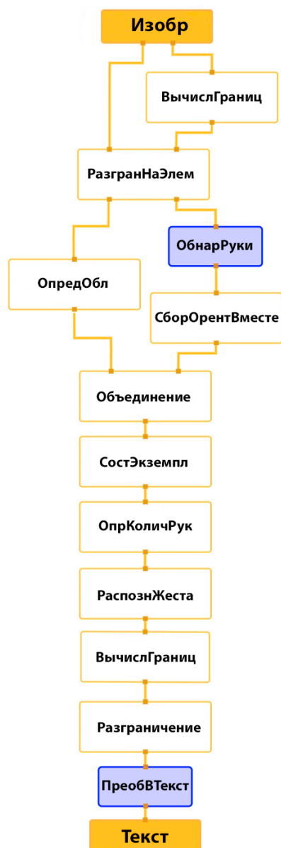
Рис. 6. Алгоритм перевода жеста на изображении в текст
