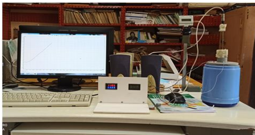
Рисунок 2. Опытный стенд для определения теплоемкости жидких материалов
