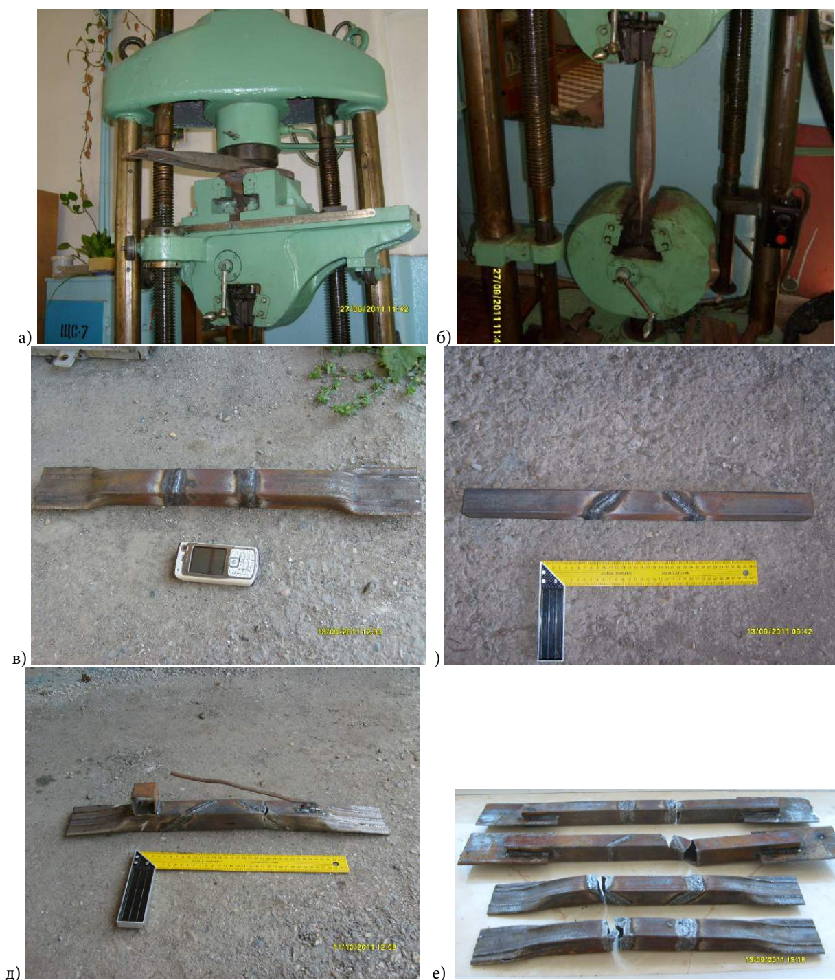
Рис. 4. Снимки экспериментального определения разрывных усилий опытных образцов «монтажных окон» поясных элементов перекрестных ферм: а – подготовка (сплющивание торцевых сечений) образца без сварных швов («эталона») к испытанию; б – нагружение «эталонного» образца в процессе испытания; в – образец с прямыми швами после подготовки к испытанию; г – образец с косыми ортогональными швами до подготовки к испытанию; д – образец с косыми диагональными швами после испытания; е – образцы после разрушения «монтажных окон», рекомендованных для применения в модулях типа «Пятигорск-2»
