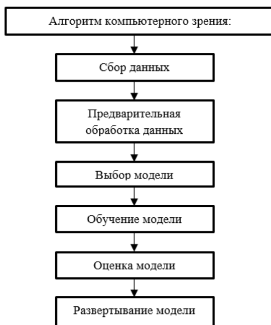
Рисунок 2 – Блок-схема алгоритма работы компьютерного зрения Figure 2 – Block diagram of the computer vision algorithm
