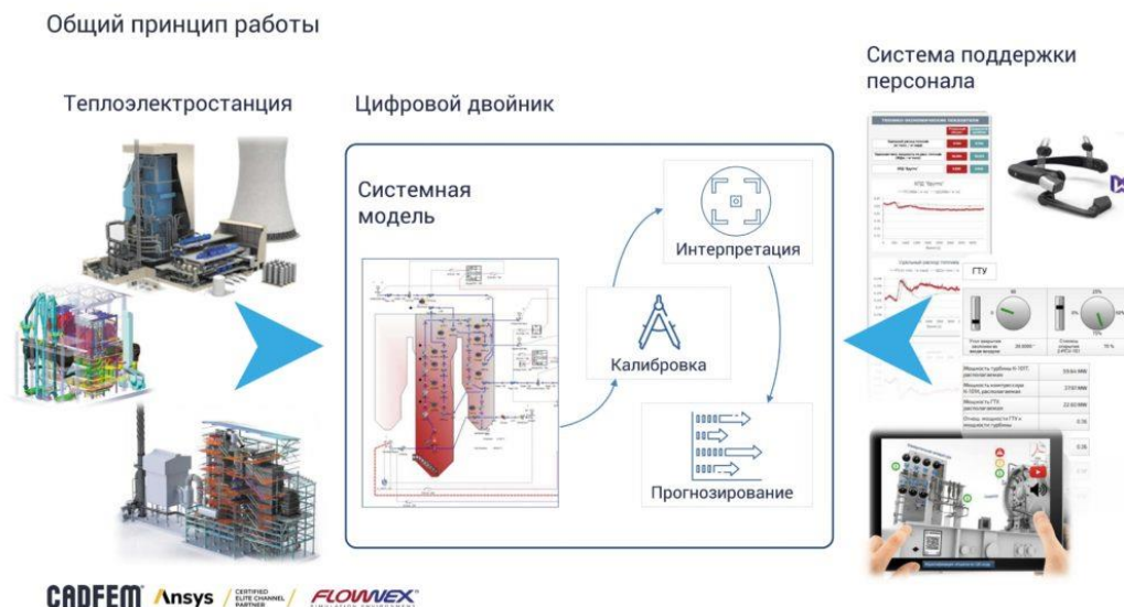
Принцип работы цифрового двойника ТЭС
