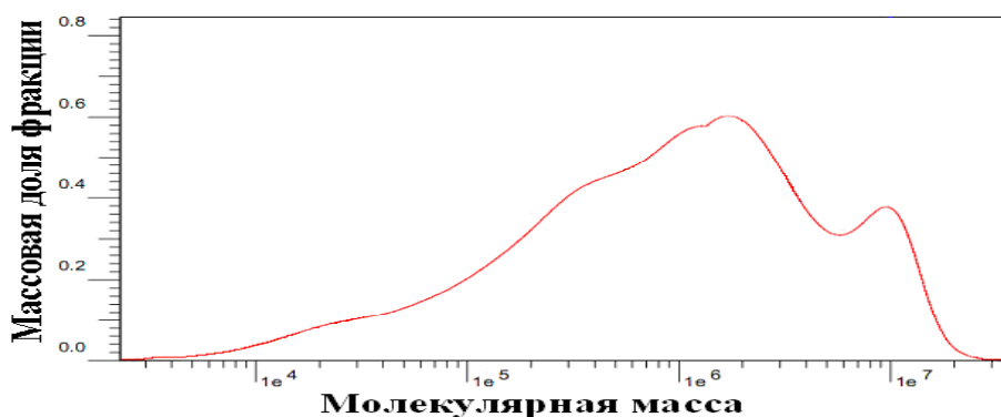
Рис. 2. Кривые ММР экструзионного пшеничного крахмала (температура экструзии 140°C, частота вращения шнеков 1,17 с -1 )
