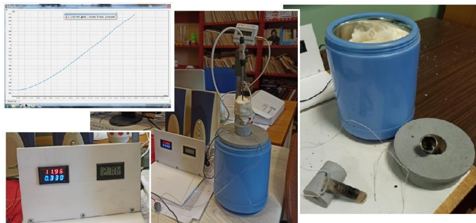
Рисунок 2. Экспериментальная установка для определения теплоемкости пищевых материалов
