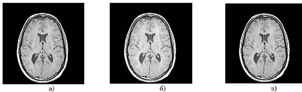
Рис. 3. Пример обработки 8-битного изображения «wmri» (15-ый кадр) вейвлетом db8 : а) исходное изображение; обработанное изображение: б) r=9 , PSNR=27,62 дБ; в) r=12 , PSNR=47,11 дБ / Fig. 3. An example of processing an 8-bit image “wmri” (15th frame) with a wavelet: a) the original image; processed image: б), dB; c), dB
