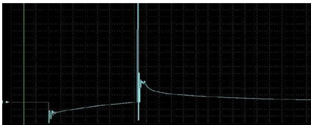
Рисунок 8 – Изображение показателей осциллограммы импульса высокого напряжения не функционирующей стержневой индивидуальной КЗ
