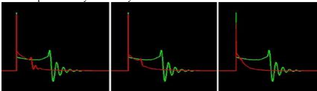
Рисунок 2-Изображение импульсов высокого напряжения, в случае катушки зажигания с межвитковым пробоем
