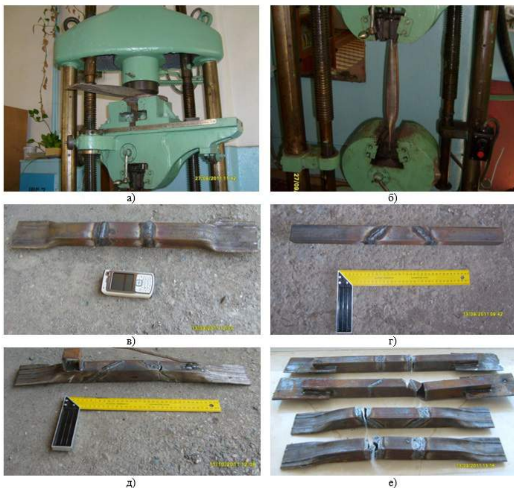
Рис. 2. Снимки экспериментального определения разрывных усилий опытных образцов монтажных окон поясных элементов перекрестных ферм: а – подготовка (сплющивание торцевых сечений) образца без сварных швов (эталона) к испытанию; б – нагружение эталонного образца в процессе испытания; в – образец с прямыми швами после подготовки к испытанию; г – образец с косыми ортогональными швами до подготовки к испытанию; д – образец с косыми диагональными швами после испытания; е – образцы после разрушения монтажных окон, рекомендованных для применения в модулях типа «Пятигорск»-2
