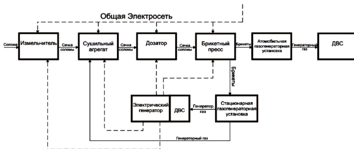
Рис. 1. Общая схема технологической линии по производству генераторного газа из соломы
