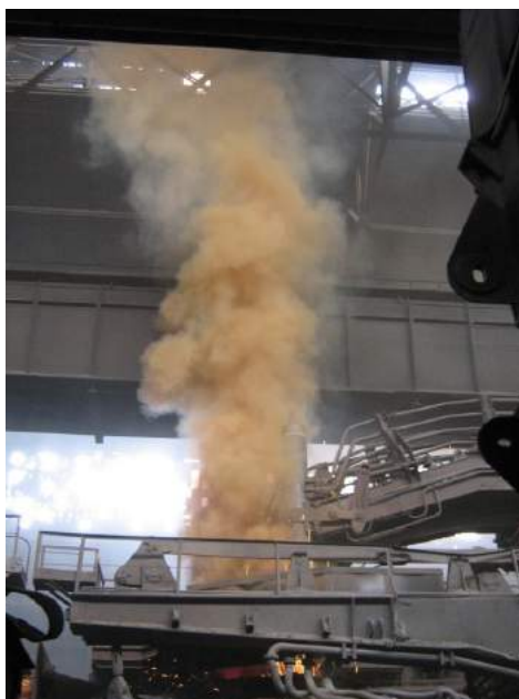
Рис. 2. Выделение пыли через межэлектродные отверстия электросталеплавильной печи ДСП-200
