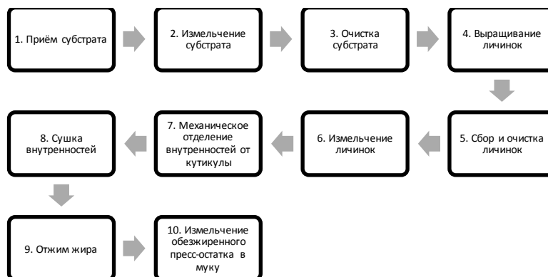
Рис. 3. Блок схема переработки насекомых в протеино-вую муку
