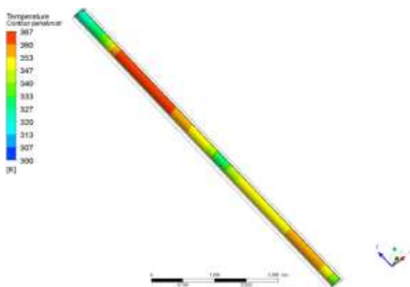
Рис. 8. Распределение температуры на внутренней поверхности пеналов
