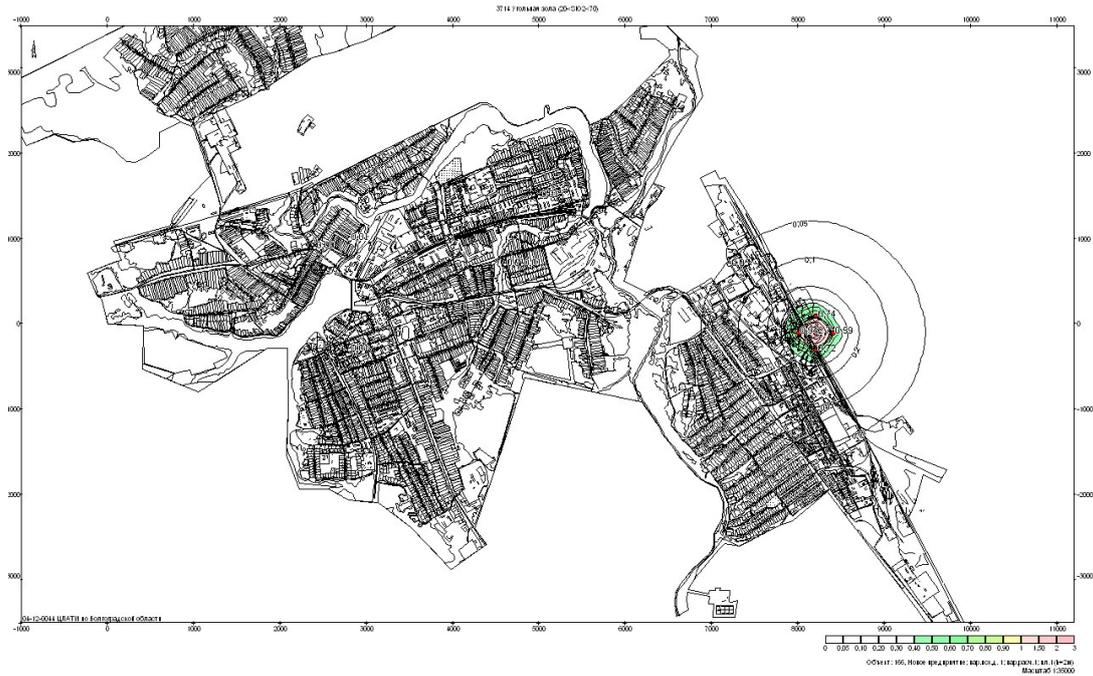
Рисунок 4 – Карта рассеивания примеси-пыли – результат сводного расчета в г. Кирове
