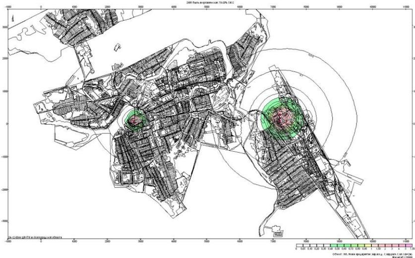
Рисунок 2 – Карта рассеивания примеси-пыли – результат сводного расчета в г. Кирове
