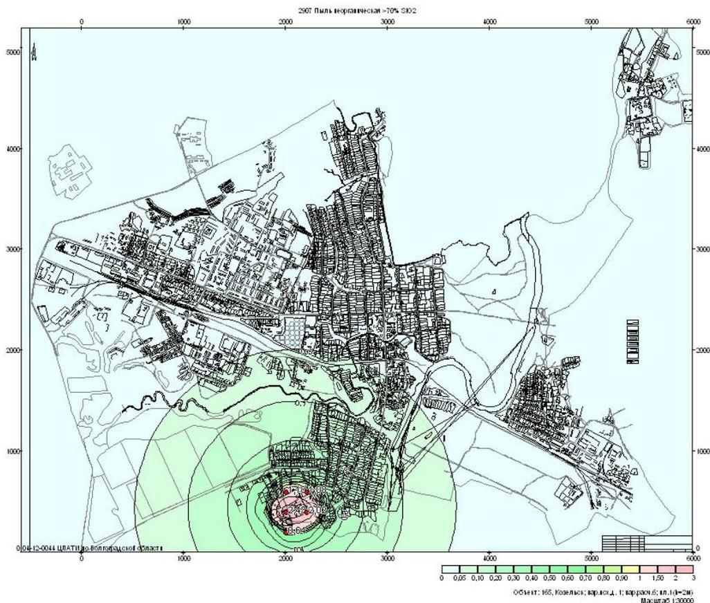
Рисунок 8 – Карта рассеивания примеси-пыли – результат сводного расчета в г. Козельске
